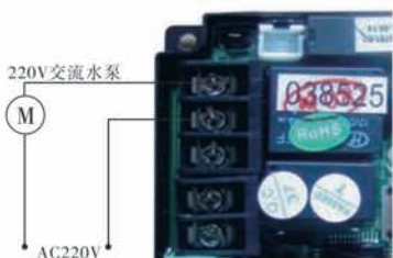
图3-8 进口接增压泵的接线图
