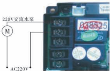
图3-7 进口接增压泵的接线图
