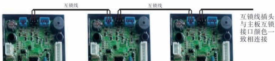
图3-9 互锁的接线图
